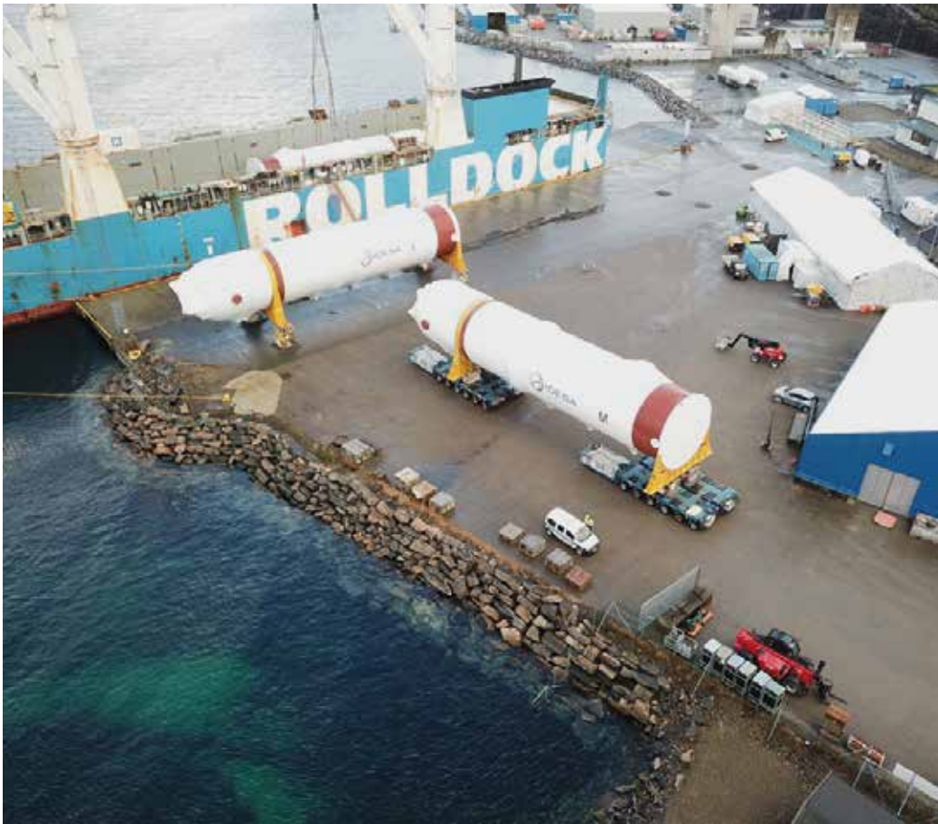
Herausfordernder Ladungsumschlag im norwegischen Kollsnes: Jeder der zwölf CSS-Tanks wiegt rund 230 Tonnen
