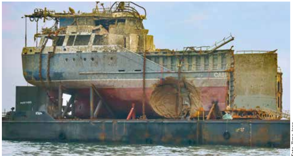
Die Hecksektion der „Verity“ nach der Bergung vor Helgoland – mit massiven Havarieschäden
