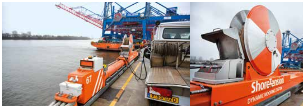
Erfolgreiche Premiere bei der Anlieferung von Containerbrücken am CTA auf einem Schwergutschiff: Mit dem dynamisch arbeitenden ShoreTension-System will HLM das Festmachen auf ein neues Level bringen
