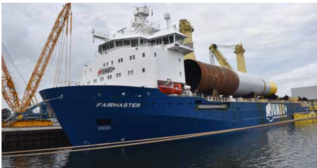
Von EEW Special Pipe Constructions im Hafen produzierte Monopiles werden regelmäßig in alle Welt verschifft
