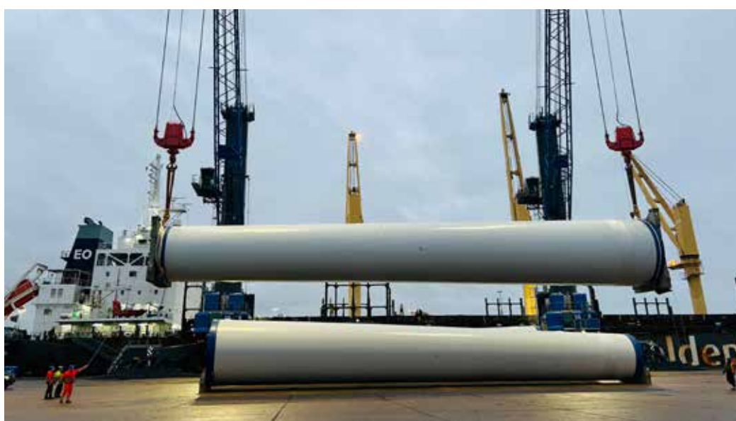
Zwei Liebherr-Hafenmobilkranen von Euroports Germany agieren bei Verladearbeiten auch im Tandem
